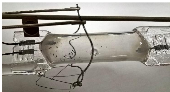
Obr. 2.11: Ukázka směšové výbojky (pohled na rtuťový hořák a wolframové vlákno) [11]
